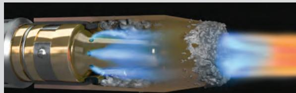
Durante el proceso de soldadura, las boquillas y puntas de soldadura se obstruyen con salpicaduras calientes que se fusionan con la boquilla, creando una obstrucción. Esto evita que el gas protector fluya libremente y caliente de manera uniforme.
